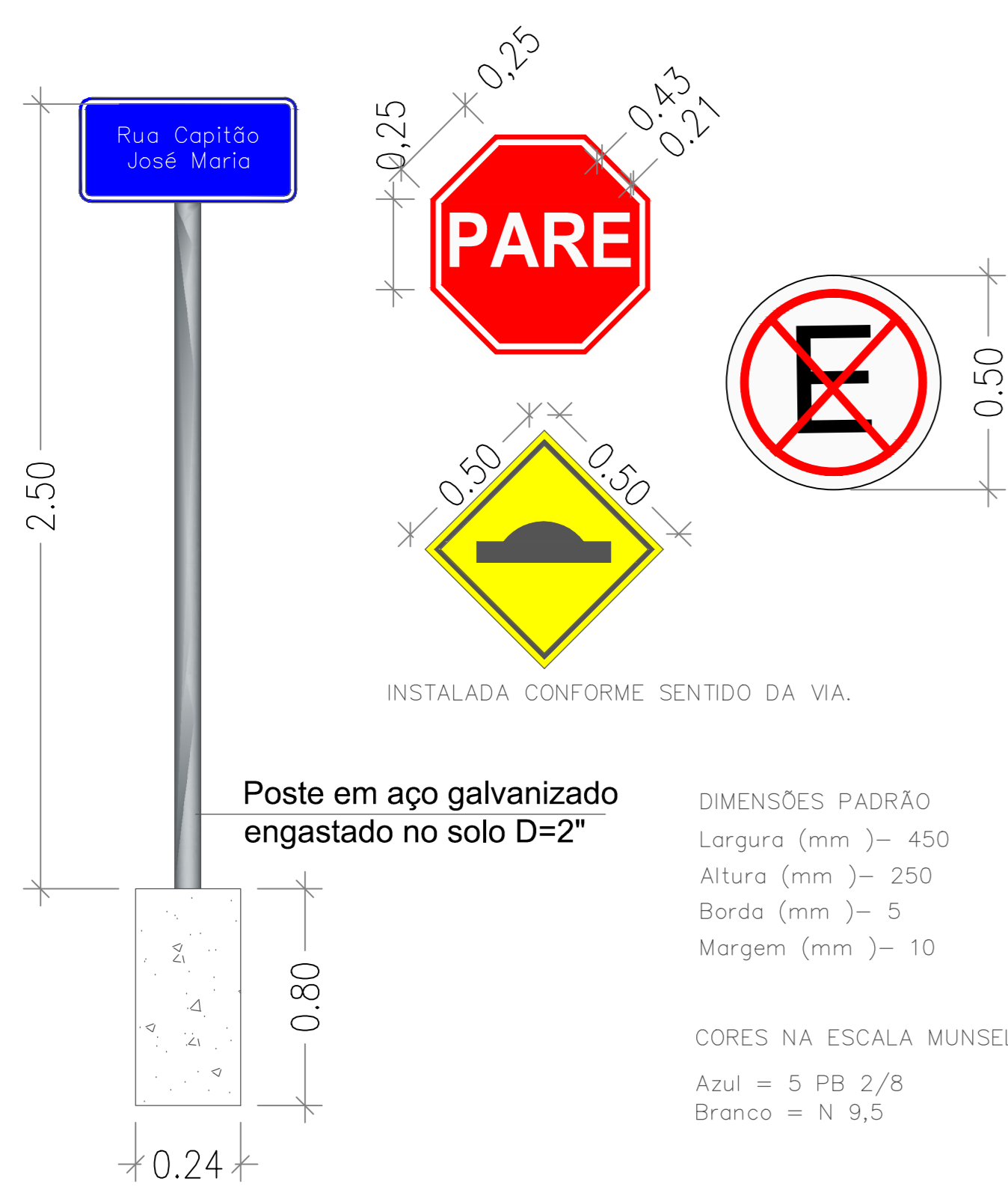
5 DETALHAMENTO DA SINALIZAÇÃO SEM ESCALA
